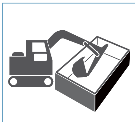
僅有挖土機和鋼槽也可進行處理
